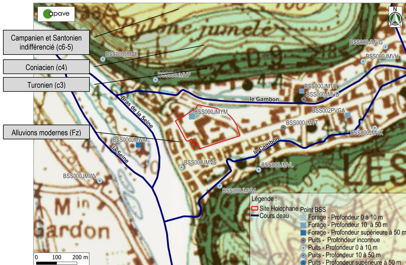
Figure 12 : Formations géologiques au droit du site (source Infoterre)
